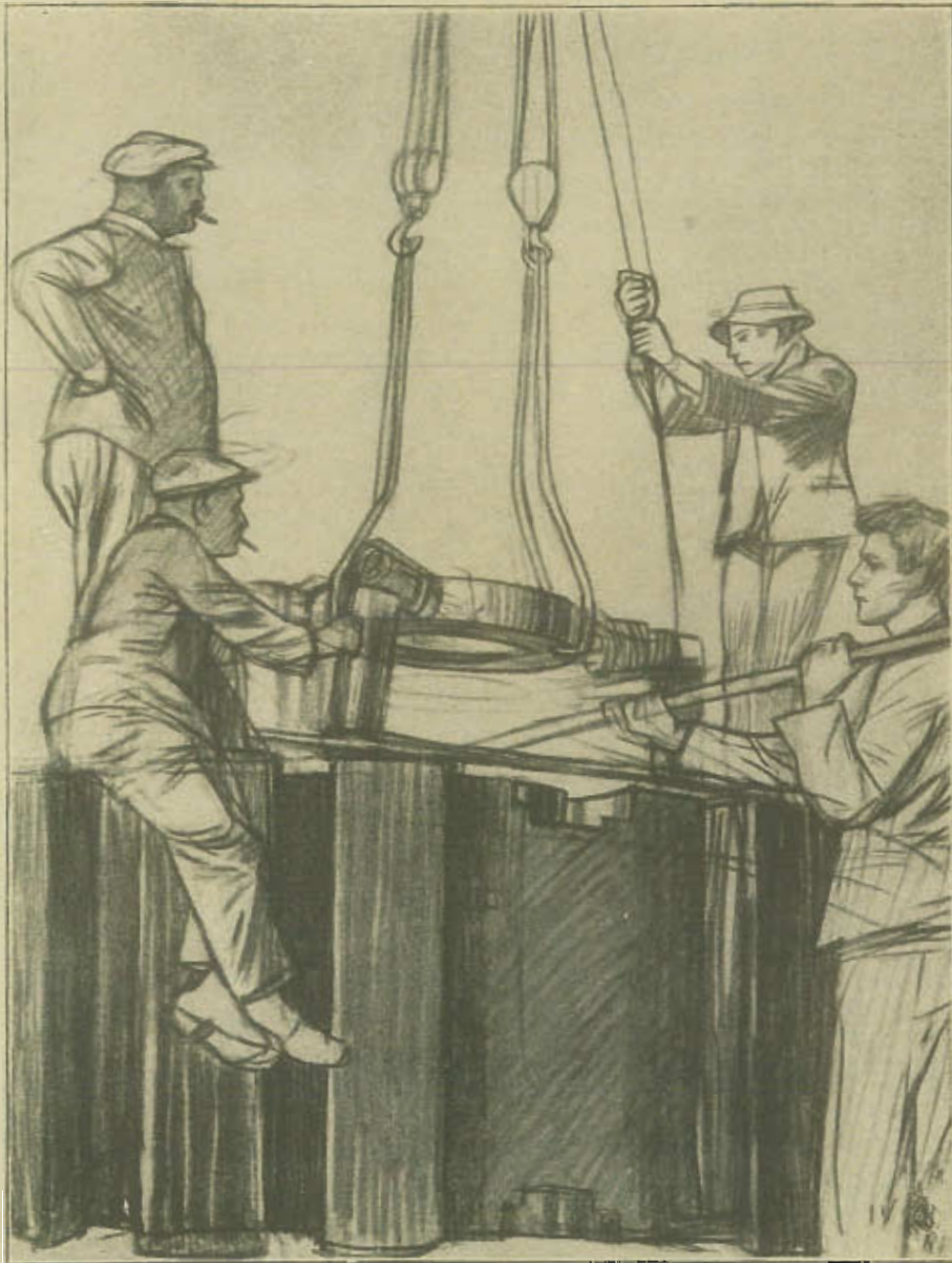
Auffegen eines Schrumpfrings auf das Volutrad
