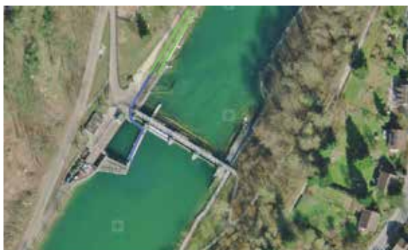
Neubau und Bestandssanierung des bestehenden FP als VSP mit neuer Linienführung (grün: Neubau VSP mit mindestens einem Einstieg, blau: Freispiegelgerinne in der bestehenden Bausubstanz) (Darstellung: PV Bern)
