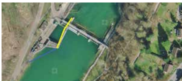
Schräg angeströmter, horizontaler Feinrechen vor dem Einlauf des Kraftwerks (blau: Horizontalrechen, gelb: Bypass-Kanal) (Darstellung: PV Bern)
