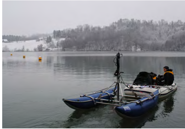
Abbildung 2: Reflexionseismische Feldkampagne (Februar 2013) mit Schlauchboot und Katamaran mit Schallquelle.
